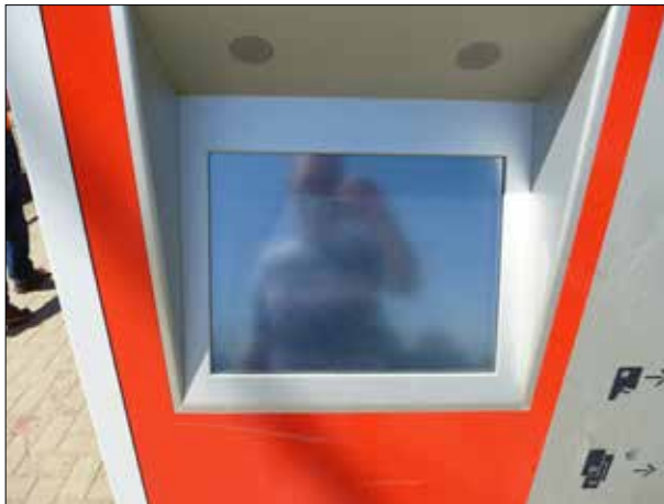
Abbildung 40: Die Anzeigen auf den Bildschirmen der Fahrkartenautomaten sind tagsüber oft nur schwer zu erkennen. Hier ist der Automat in Herzhorn zu sehen.
