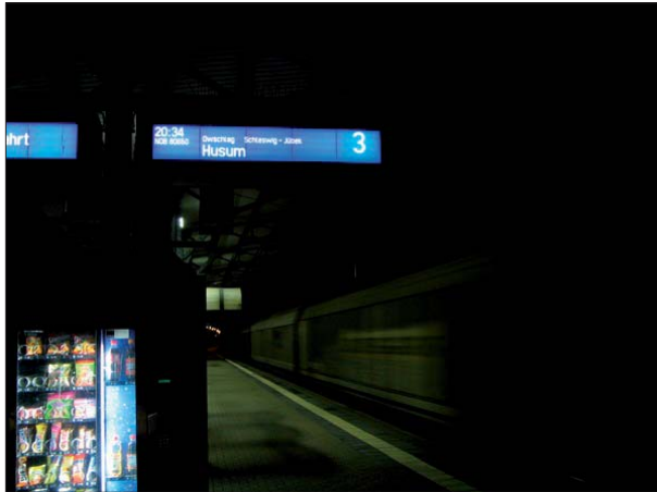
Abbildung 17: Dieser Zugzielanzeiger in Rendsburg zeigte bei der Durchfahrt eines Güterzuges weiter den Zug nach Husum an, anstatt auf die Zugdurchfahrt hinzuweisen.
