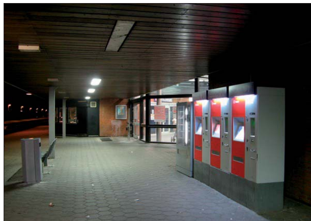
Abbildung 48: Unter dem Bahnsteigdach von Eckernförde waren insgesamt drei Lampenhäusen beschädigt, und eine dieser Lampen leuchtete nicht.
