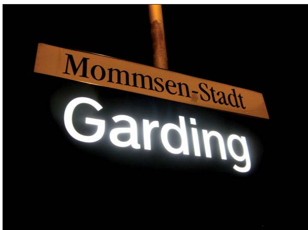
Abbildung 21: Auch Garding besitzt jetzt ein vandalismus-resistentes hinterleuchtetes Stationsschild mit Blechhaube und ausgefrästen Buchstaben. Die Verwendung dieses bewährten Schildertyps schreitet allerdings nur langsam voran.
