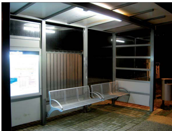
Abbildung 57: Im Unterstand von Tating wurden die kleinteiligen Fenster in zwei Segmenten nach Vandalismusschäden durch große Scheiben ersetzt.
