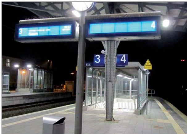
Abbildung 16: In Rendsburg verdecken die überflüssigen Gleisnummernschilder an den Dachstützen die neuen Wegeleitungsschilder über den Treppenabgängen.
