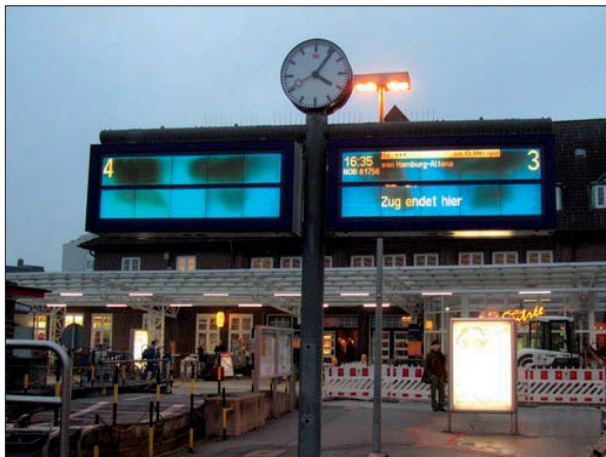
Abbildung 17: In den Anzeigebereichen der Zugzielanzeiger in Westerland haben sich schwarze Flecken gebildet.
