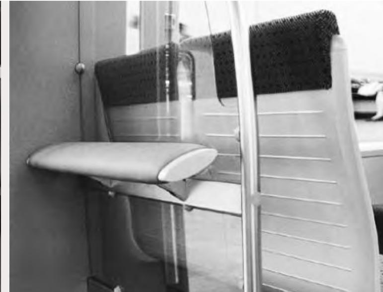
Klappsitze müssen grundsätzlich in Form, Materialwahl und Oberfläche so gestaltet sein, dass sie im hochgeklappten Zustand als Anlehnplätze genutzt werden können. Komfort-Einbußen durch scharfe Kanten, ungeeignete Neigungswinkel, kalte Materialien o. ä. sind dabei zu vermeiden.
